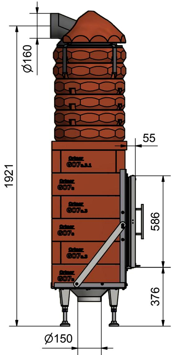
Alle Höhenangaben gelten bei einer Mörtelfugenstärke von 3 mm, einer Fasermattenstärke von 3 mm (im zusammengedrückten Zustand) und vollständig hochgeschraubtem Grundgestell.
